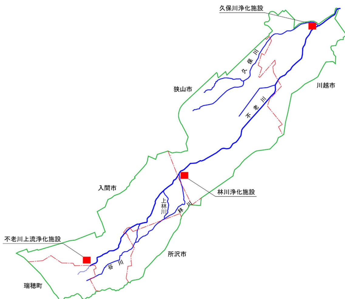
図 5.5 河川浄化施設設置箇所
