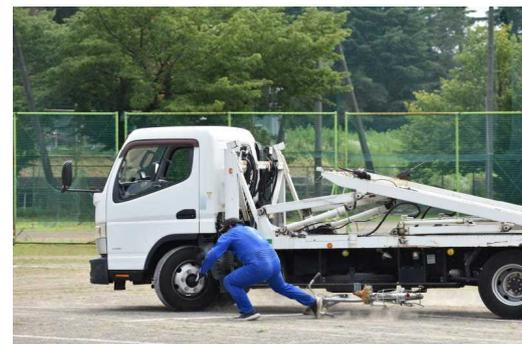
【 大型車両の左折時に、内輪差により自転車が巻き込まれ転倒する瞬間 】
