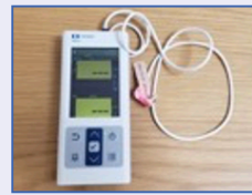
動脈血酸素飽和度測定器。指先など の皮膚を通して、動脈血酸素飽和度 (SpO2) と脈拍数を測定する装置
