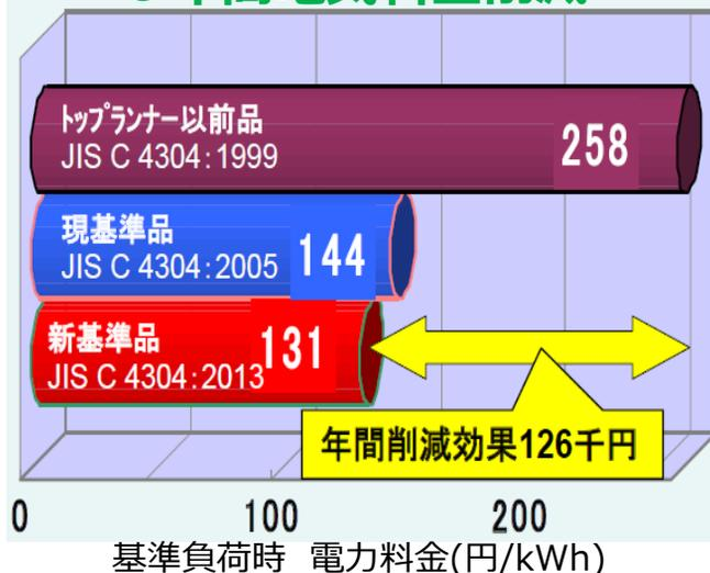
※三相50Hz 500kVA油入変圧器(基準負荷率40%)をトッランナー油入変圧器に交換した場合
