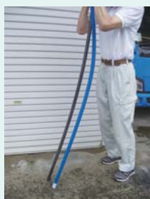
↑青がポリエチレン管。黒が塩化ビニール管
