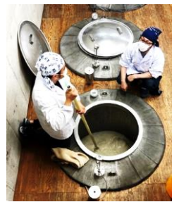
「かけ米」を2階に運び、タンクに移し入れ、櫂(かい)で混ぜる。
