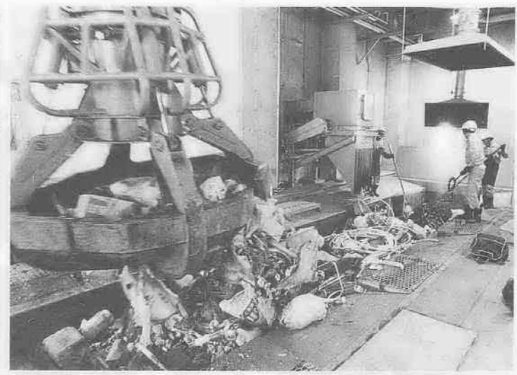
ピットからコンベアに出され、危険物の混入を調べます。
