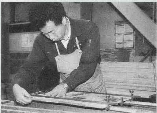
板にのりを付けて固定し、幅の広い板にする工程。「板はぎ」と呼ばれます。
