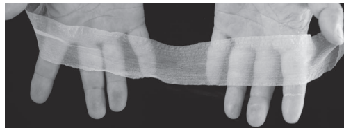
削られた鉋屑はとても薄く、 持つ手が透けて見えてしまうほど
