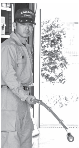
捜索活動の際に役立った「ポーカメ」先端に付いているカメラでガレキの中を見ることができます
