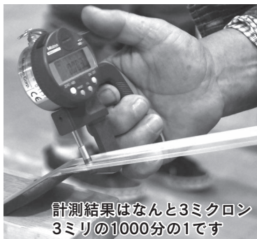
大鉋による薄削り 鉋だけでもかなりの重さです
