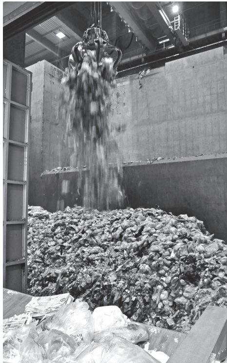
搬入したごみをピットに落とすごみ収集車(上写真)と資源化センターのごみピット(右写真) 家庭から出る可燃ごみ(収集日1日当たり)は、市全体でおよそ300t、約150台のごみ収集車で運びます
