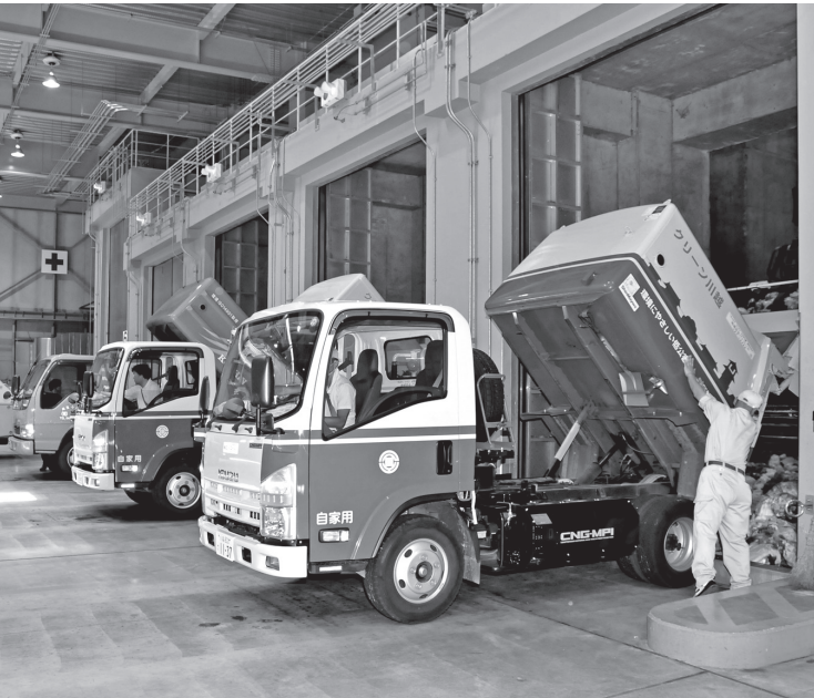
搬入したごみをピットに落とすごみ収集車(上写真)と資源化センターのごみピット(右写真) 家庭から出る可燃ごみ(収集日1日当たり)は、市全体でおよそ300t、約150台のごみ収集車で運びます
