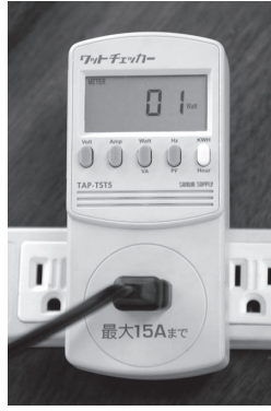
リアルタイムで家電製品の消費電力を測定できます
