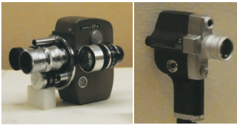
手巻き式8mmカメラ(左)と、電動式8mmカメラ(右)
