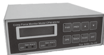
自動車や民生用ワイヤーハーネスのさまざまな圧力不良をリアルタイムで全数検査する装置
