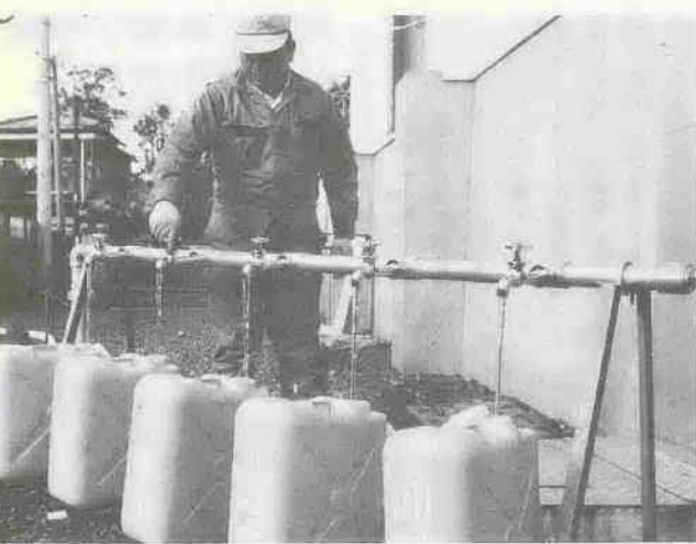
市内8か所の浄水場と2か所の深井戸に路上給水装置(写真)が用意されている。地震に強いといわれる深井戸や浄水場の配水池から直接水をくみあげ急場をしのぐというもので、もし家庭の水道が使えなくなった場合、市中の消火栓につなぎ、その場で給水もできるというしくみになっている。
