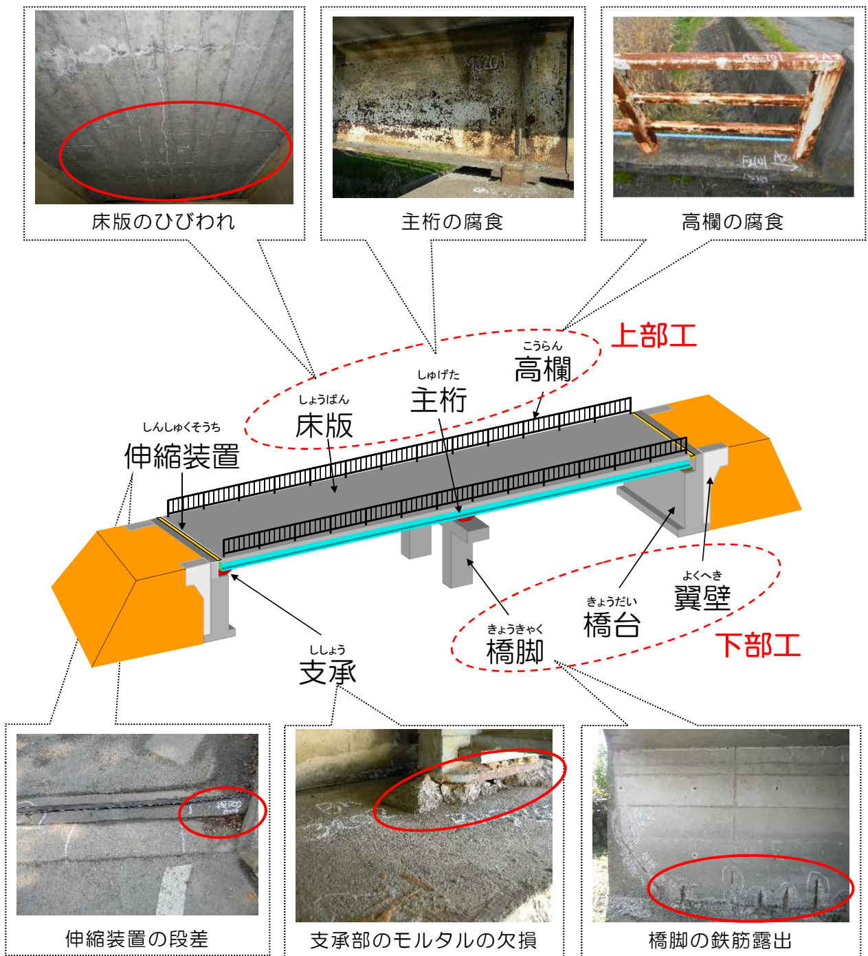
図 4.3 各部材の損傷状況
