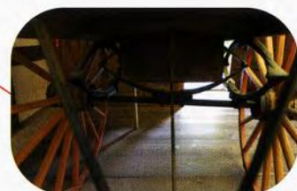
板バネ式のサスペンション構造
